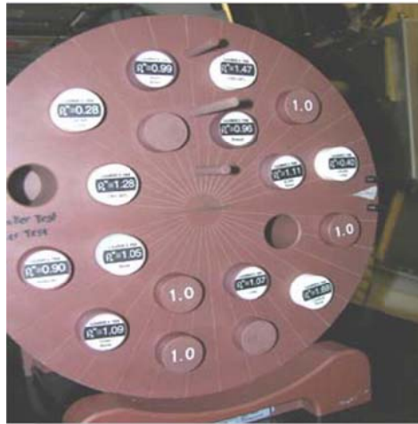
图 B.9 MVCT 图像低对比度分辨率检测示意图
