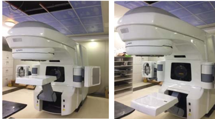
图 15 EPID 沿 Z 轴方向运动到最高和最低
