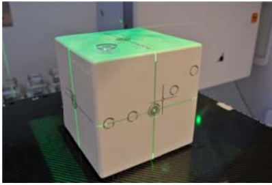
图 5a 将模体中心标记与 激光灯重合
