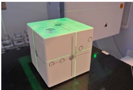
图 3a 将模体移动一定距离,模拟发生摆位误差
