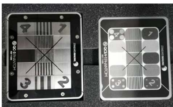
图 7a 用于 MV/kV 的二维图像高对比度分辨率 测试模体
