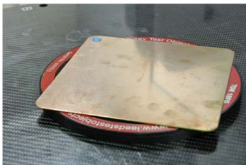
图 8c 用于 kV 的二维图像低对比度分辨率 测试模体
