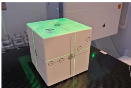
图 4a 将模体移动一定距离,模拟摆位误差
