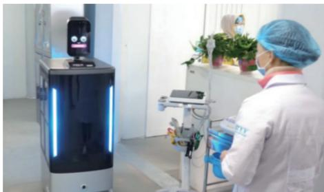
2月4日，智能疫情协作服务机器人“抵达”北京市海淀区医院，协助医生进行无人导诊，自动响应发热问诊、引领患者及初步诊疗，并可实现医生对患者的远程诊疗，避免医护人员与病患直接接触而发生交叉感染可能性。
